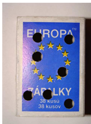
Obr.2: Dierkovačom perforovaná krabička zabezpečuje, aby vzorka neporástla plesňami. Pred predierkovaním vrchnáka vyberte vysúvaciu časť, aby ostala neporušená.
